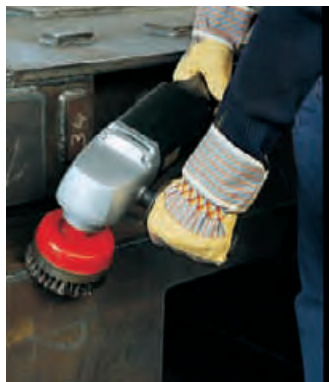
Topfbürste und Winkelschleifer im Einsatz.
