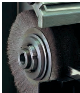
Schnittkanten-entgraten von Rohr-Abschnitten auf einer Tisch-entgratmaschine.
