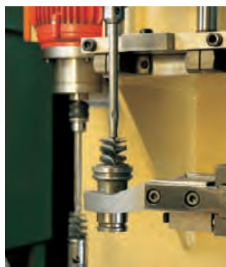
Eine Innenbürste entgratet Querbohrungen in einem Ventilkörper.
