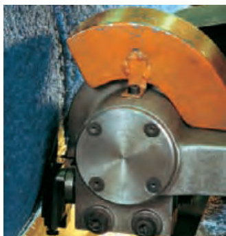
Der Abschervvorgang an einer Walzenbürste
