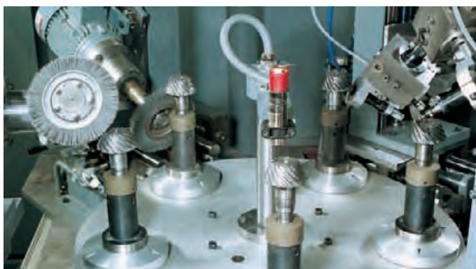
Die Rundtisch-Entgratmaschine mit zwei Vorschleif- und zwei Bürstenstationen.
