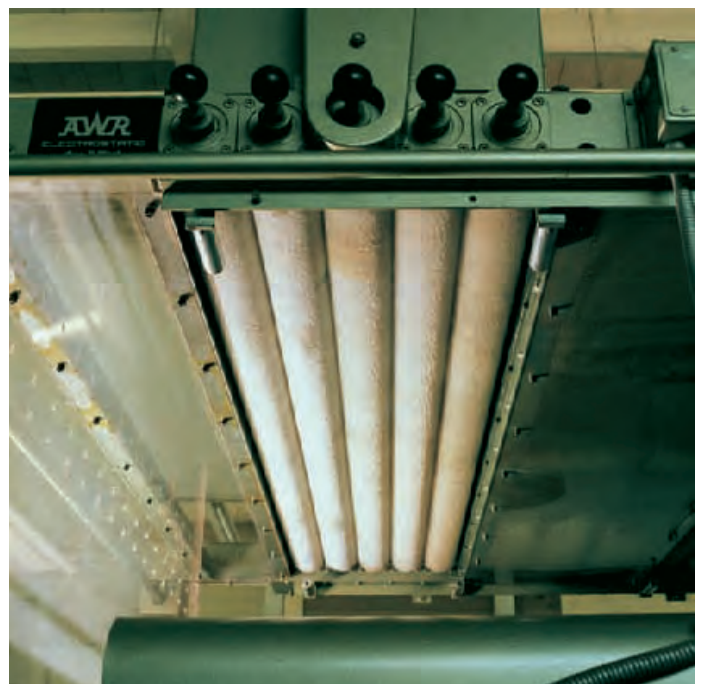
Walzenbürsten verteilen die Flockmasse in Textil-Beflockungsmaschinen
