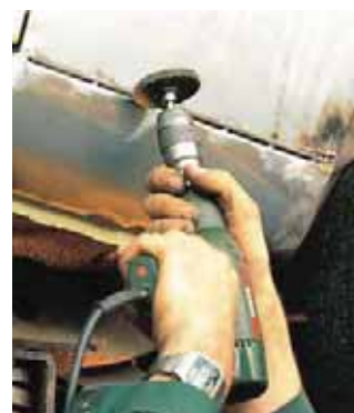
Schweißnahtbearbeitung mit einer Delta Schafrundbürste.
