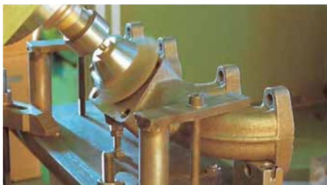
Stirnflächen-Entgraten an einem Fächerkrümmer mit einer Record Schafttopfbürste.
