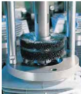
Zwei Alpha Einzelscheiben-Bürsten honen einen Zylinderkopf.
