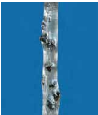
Mikroskopische Abbildung einer ANDERLON-Schleifbürste mit Silicium-Carbid-Korn.
