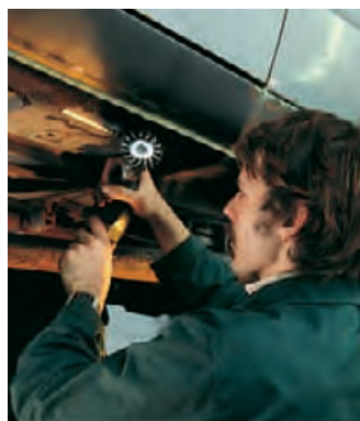
Entfernen von Unterbodenschutz mit einer Ultra Schaftgrundbürste.
