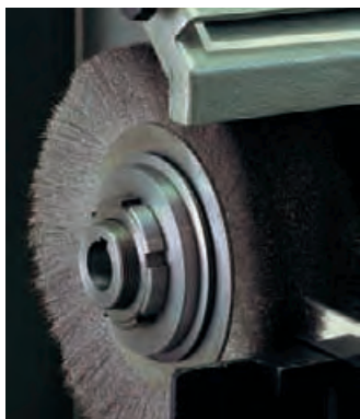
Schnittkanten-entgraten von Rohr-Abschnitten auf einer Tisch-entgratmaschine.
