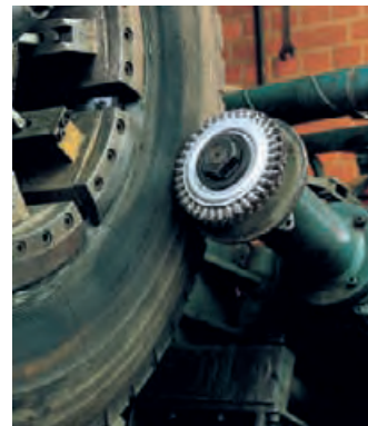
Aufräumen vor der Runderneuerung mit Ultra Rundbürsten – so ermöglicht Bürstentechnik auch Recycling.
