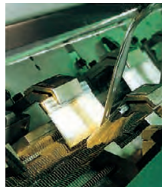
Damit die Produktion nie den Faden verliert: Bürsten öffnen und schließen Nadeln in Strickmaschinen.
