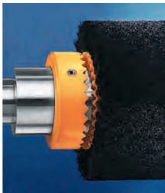
Standard-Stelling verzahnt. Mit diesen Stellingrings werden die Körpersegmente beidseitig auf dem Körper fixiert.
