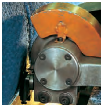
Der Abschervvorgang an einer Walzenbürste
