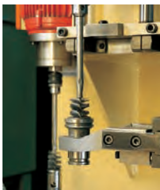
Eine Innenbürste entgratet Querbohrungen in einem Ventilkörper.
