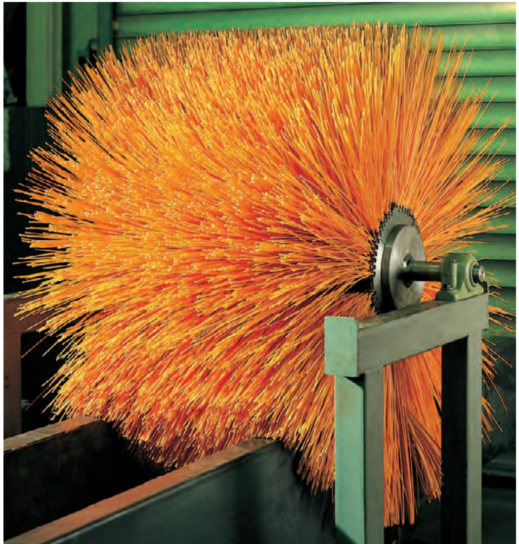
Entfernen der Strahlmittel auf Profilen in Durchlauf-Schleuderstrahlanlagen
