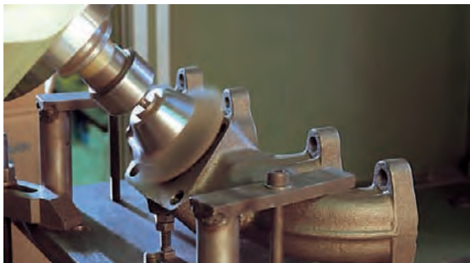
Stirnflächen-Entgraten an einem Fächerkrümmer mit einer Record Schafttopfbürste.
